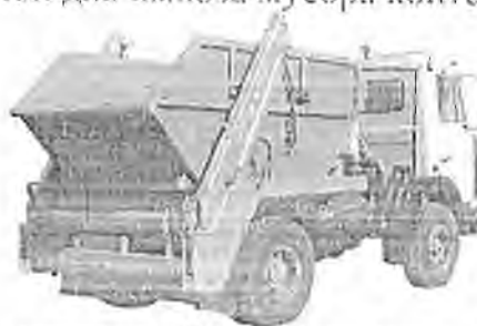
Рис. 4.16. Бункеровоз МКС-3501 на шасси MAZ-5551A2
